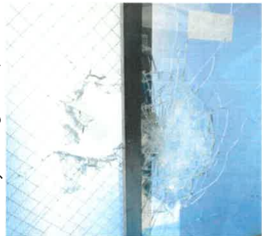
防犯合わせガラス(右)と網入りガラスをハンマーで殴防した実験(旭化成ホームズ提供) 東京新聞より 抜粋
