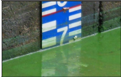
第一調整池 水位3.71m
